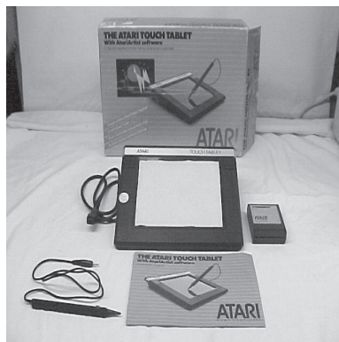
Touch tablet คือ ส่วนที่เป็น tablet ที่วางติดอยู่กับเครื่อง คอมพิวเตอร์ที่จะมีขอบบนหรือเส้นนั้นขึ้นมาเหมือนบนหน้าจอ และเมื่อใช้มือแตะตรงส่วนไหน คอมพิวเตอร์ก็จะอ่านข้อความ ตรงนั้นให้
